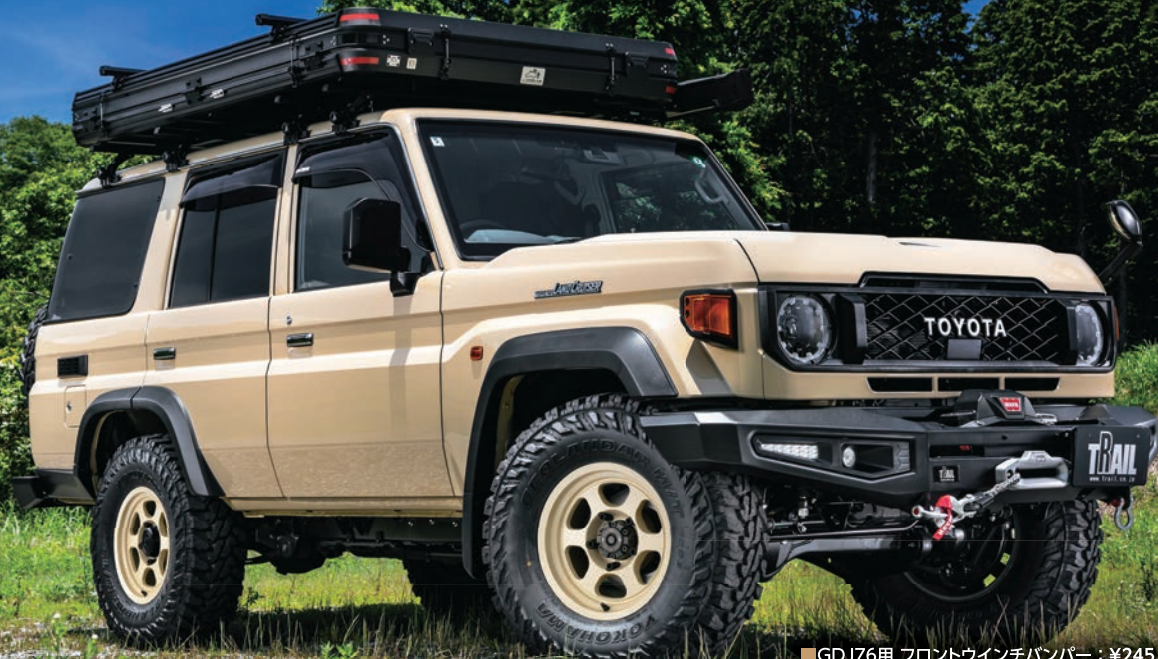
■GDJ76用 フロントウインチバンパー：¥245,300(税込¥269,830) WARN ZEON, VR EVO, 他シリーズのウインチ搭載可能。LEDフォグランプ及びLEDウインカー&ポジションランプ内蔵。アッパーカバー、左右にDジャックル標準装備。※ウインチとアッパーカバーの同時装着不可。
