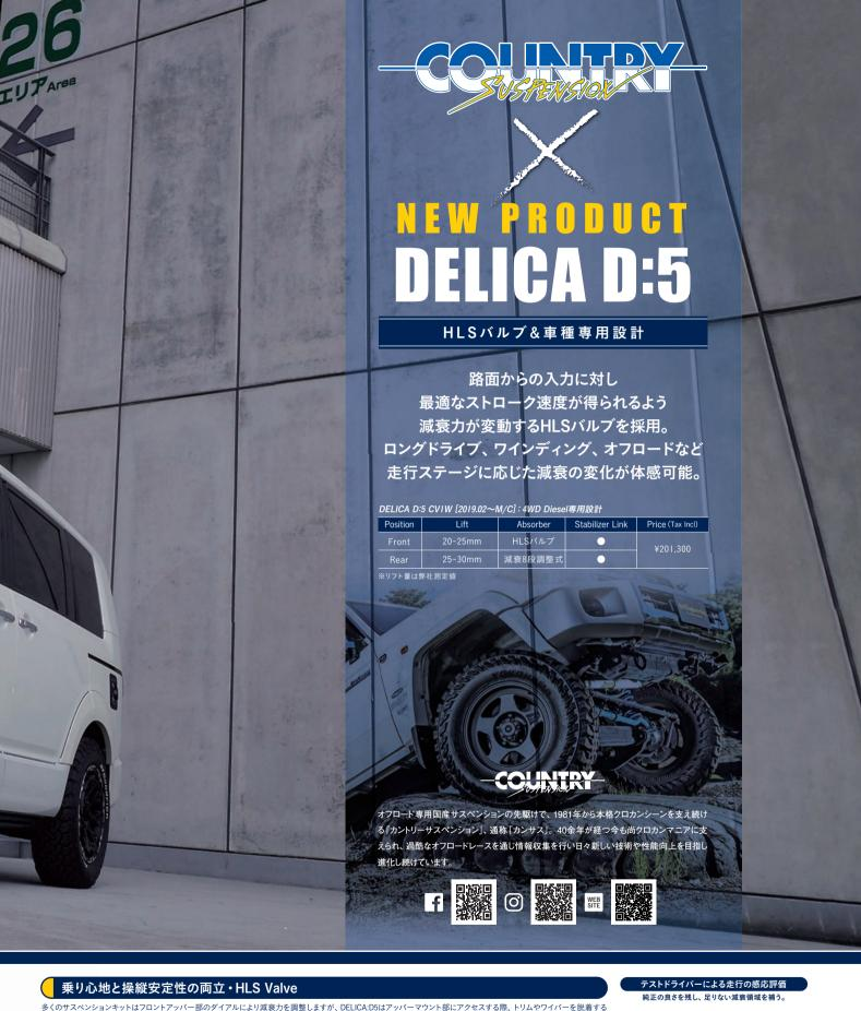
多くのサスペンションキットはフロントアッパー部のダイアルにより減衰力を調整しますが、DELICA:D5はアッパーマウント部にアクセスする際、トリムやワイパーを脱着する 必要があり減衰力調整を安易に行うことが出来ません。カントリーサスペンションキットではフロントショックアブソーバーに新たに「HSLバルブ」を採用することで路面から の入力に対して減衰力が変動、最適なストローク速度が得られることでロングドライブ、ワインディング、オフロード走行などそれぞれに最適なトラクションを確保。減衰力 の調整機能が無しで走行ステージに最適な減衰の変化を体感できます。
