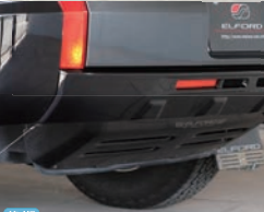
後期 ■ ブラックレボルシオンマフラー ・適合エンジン型式:4N14(DI-Dクリーンディーゼル) ・SUS304 ステンレスマフラー ・保安基準適合品 (交換用マフラー事前認証制度対応マフラー) ¥84,260(税込)
